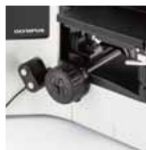
用于旋转电动物镜转换器的手动开关
